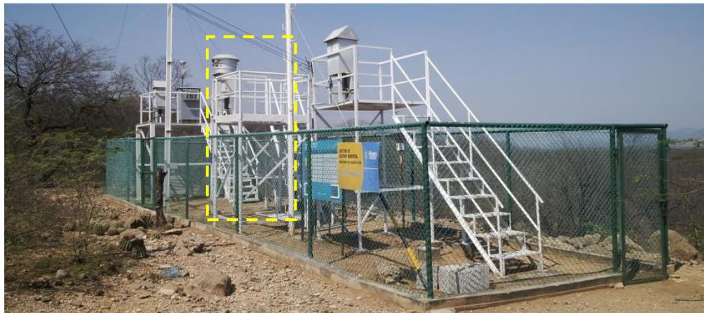
*Figura 8. Instalación del equipo TE-6070DV-BL sin escobillas en la Estación Provincial*
