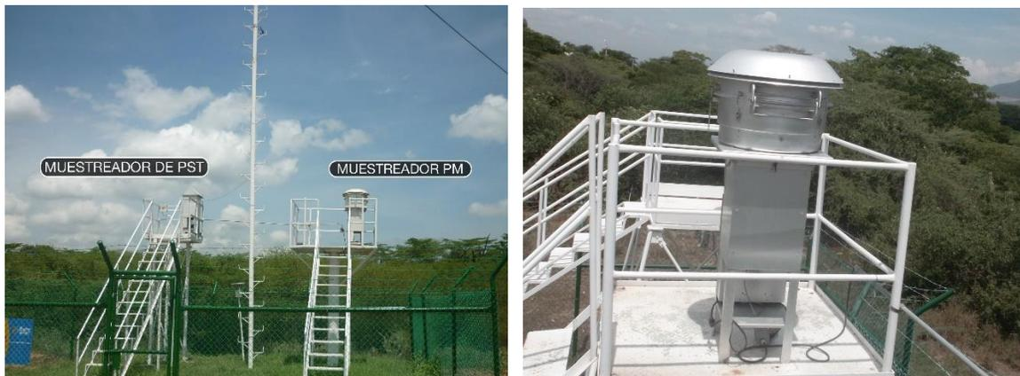
Figura 6. Muestreadores de alto volumen TE-6070 y TE-5170 para la determinación de PM<sub>10</sub> y TSP por método gravimétrico, de la red del Cerrejón.
