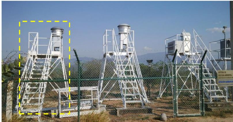
Figura 9. Instalación del equipo TE-6070DV-BL sin escobillas en la Estación Barrancas
