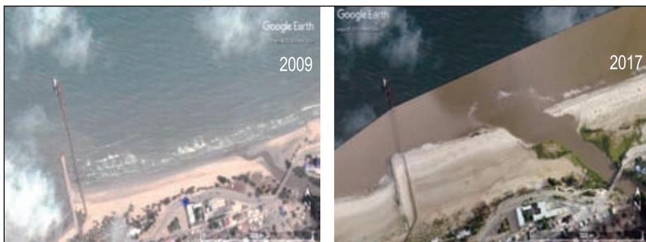
**Figura 3.** Cambios significativos locales en la línea de costa por artefactos (espigones, desembocadura Rio Ranchería). Izquierda, año 2009 justo después de su construcción (**Fuente:** Digital Globe). Derecha, seguimiento con RPAs Phantom año 2017/06/15 (**Fuente:** propia).
