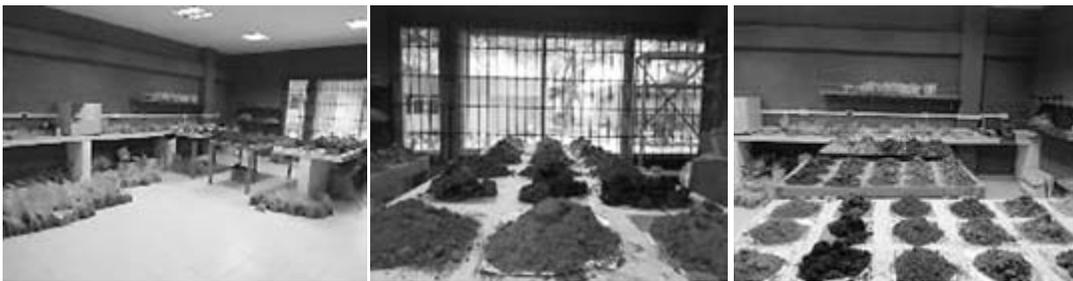
**Figura 7** Preparación, secado y tamizado inicial de muestras de suelos. Laboratorio de Ciencias Ambientales Universidad de La Guajira.
