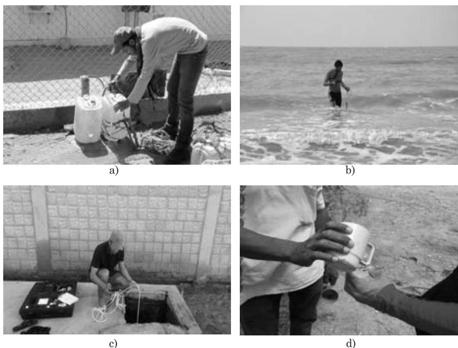
**Figura 3.** Toma de muestras y lectura de parámetros fisicoquímicos con sondas. (a) Toma de muestra en punto de suministro ubicado en la base militar de Punta espada. (b y c) Lectura de parámetros fisicoquímicos en playas de Parajimarú y Planta desalinizadora del municipio de Mayapo. (d) Muestra de agua jagüey para consumo tomada en la comunidad Piedras blancas, en Manaure.
