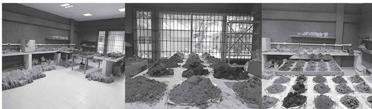
**Figura 18.** Preparación, secado y tamizado inicial de muestras de suelos.
