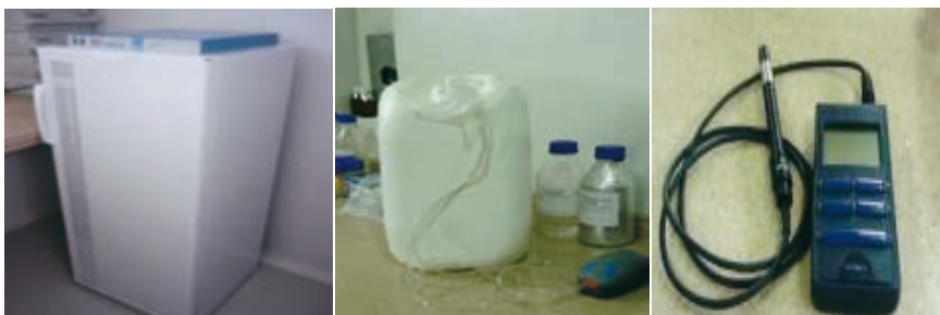
Figura 14. Equipos utilizados para medir demanda bioquímica de oxígeno, durante los ensayos experimentales.
