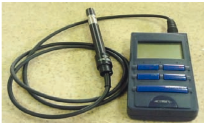
Figura 12. Equipo utilizado para medir oxígeno disuelto durante los ensayos experimentales.
