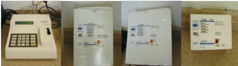
Figura 17. Equipo utilizado para medir amonio, nitrito y nitrato, durante los ensayos experimentales.
