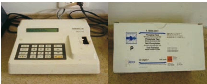
Figura 18. Equipo utilizado para medir los ortofosfatos, durante los ensayos experimentales.
