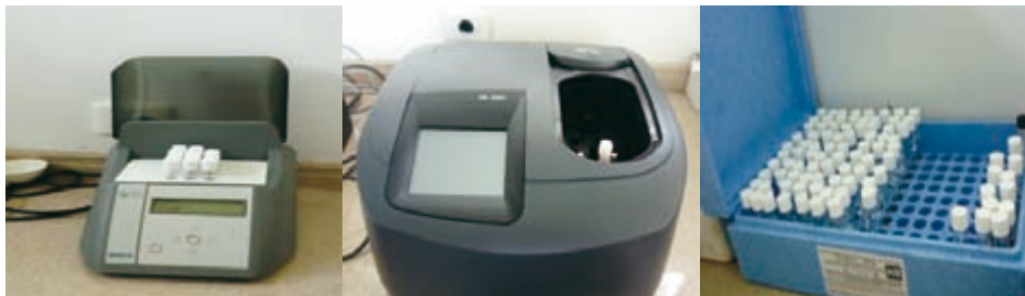
Figura 15. Equipos utilizados para medir demanda química de oxígeno, durante los ensayos experimentales.
