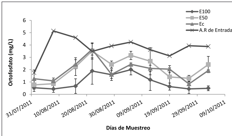
Figura 66. Comportamiento del ortofosfato durante el tratamiento biológico con Eichhornia crassipes , empleando diferentes coberturas con plantas en el sistema y una tasa de renovación de efluente de 75%. E100 y E50 %: sistemas con 100 y 50 % de cobertura con plantas, E c : sistema control (sin plantas), A.R de Entrada: agua residual de entrada. Las barras verticales indican la media aritmética \pm desviación estándar para n=3 .
