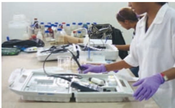
Figura 9. Equipo utilizado para medir conductividad eléctrica durante los ensayos experimentales.
