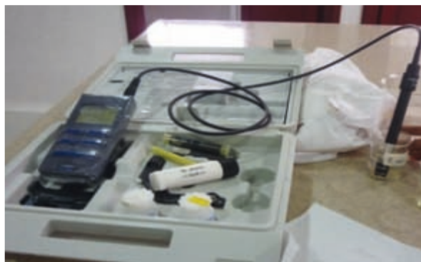
Figura 10. Equipo utilizado para medir salinidad durante los ensayos experimentales.
