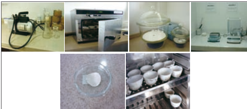
Figura 13. Equipos utilizados para medir sólidos: SST, SSV y SFT durante los ensayos experimentales.
