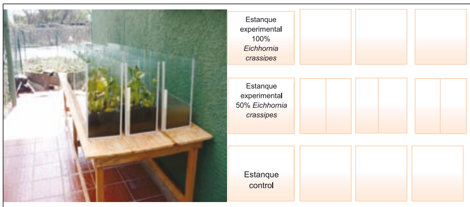
Figura 6. Diseño a escala de laboratorio del sistema de tratamiento biológico empleado para mejorar la calidad del agua residual en Riohacha, Colombia
