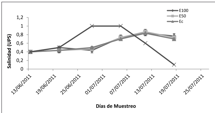
Figura 43. Comportamiento de la salinidad durante el tratamiento biológico con Eichhornia crassipes , empleando diferentes coberturas con plantas en el sistema y una tasa de renovación de efluente de 50%. E100 y E50 %: sistemas con 100 y 50% de cobertura con plantas, EC: sistema control (sin plantas), A.R de Entrada: agua residual de entrada. Las barras verticales indican la media aritmética \pm desviación estándar para n=3 .
