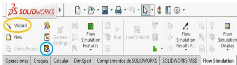
Figura 5.20. Acceso al asistente Wizard (marcado con amarillo) y a la opción Create Lips (marcado con azul) en el menú de las características de Flow Simulation .
